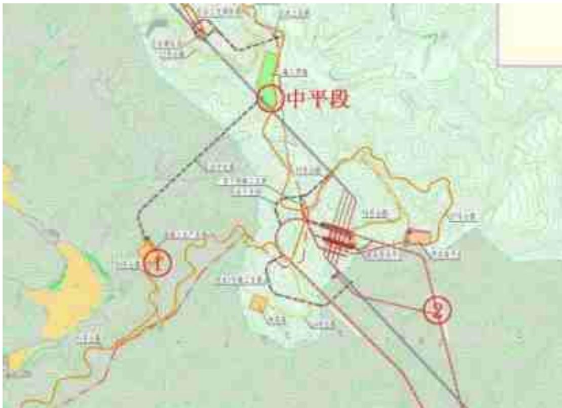
图 2-5 引水中支洞洞口方案示意图
